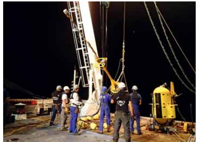
Mise à l'eau de la bouée Télémaque lors de la campagne BAMBI à bord du BHO Beautemps-Beaupré
