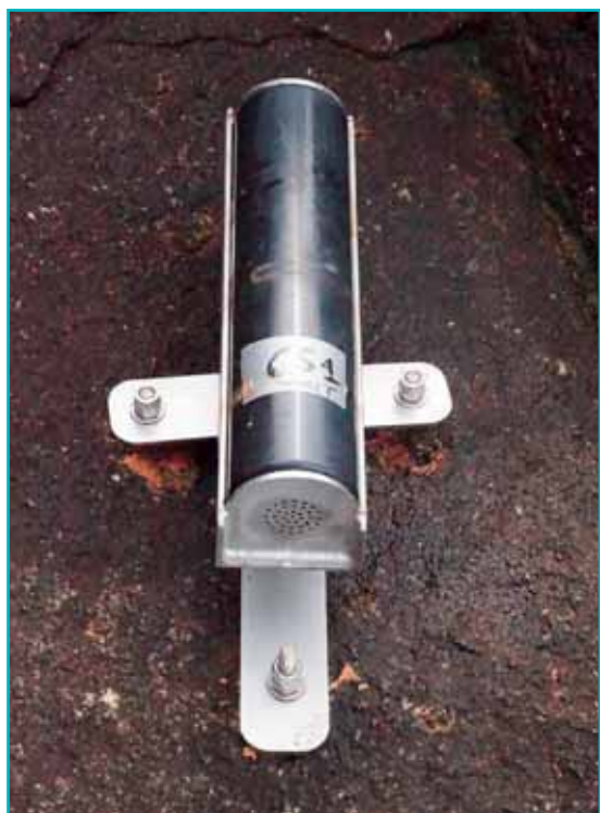
Capteur de pression OSSI sur son support
