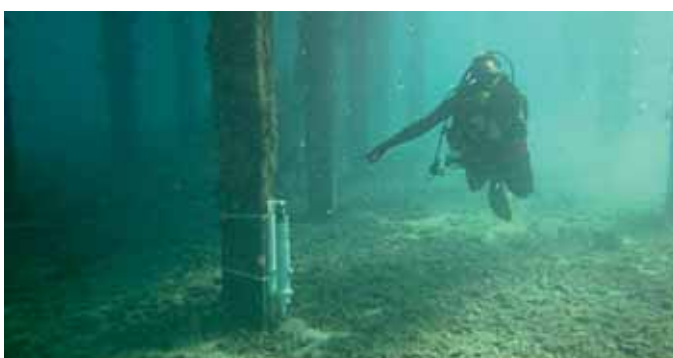
Mise en place d'un marégraphe au port de Wé (Lifou)
