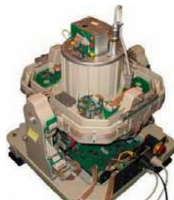
Gravimètre marin KSS32M
