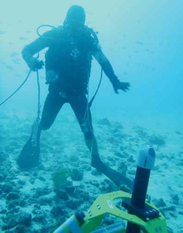
Installation d'un mouillage courantométrique par plongeur à proximité de Moroni
