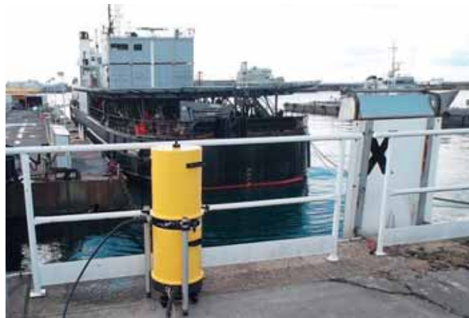
Le gravimètre absolu A10 en station de mesure dans le port de Brest
