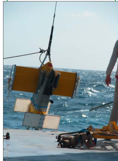
Poisson ondulant remorqué SeaSoar muni de capteurs physiques et biochimiques
