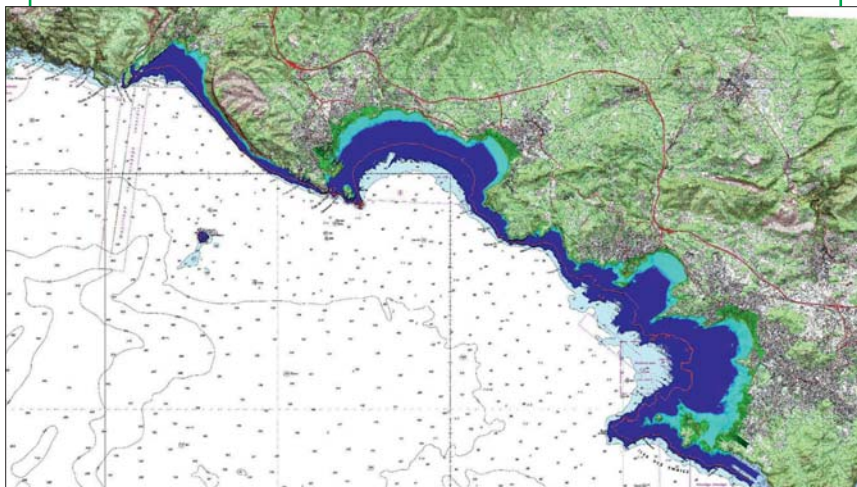
Levé laser bathymétrique Litto3D® réalisé entre Cassis et Six-Fours-les-Plages dans le cadre du projet en cours ALDES du MIMOCT et du MEEDDTL pour la modélisation de la propagation des tsunamis et l'évaluation de leur impact à la côte
