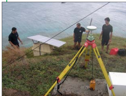
Mise en place d'une station GPS de référence avec panneaux solaires
