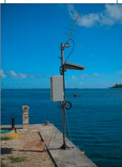
Station marégraphique de Huahine installée en avril 2010
