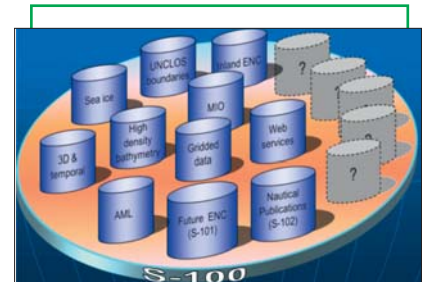
Le modèle universel de données hydrographiques S-100 de l'OHI s'appuie sur la série ISO 19100 des normes pour l'information géographique.
