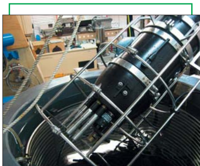
Un capteur expérimental est immergé dans la cuve d'étalonnage
