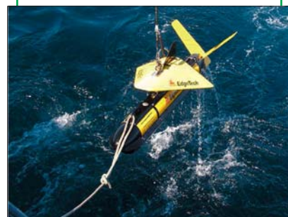
Le sonar à balayage latéral EdgeTech 4300 permet la détection des anomalies bathymétriques et l'analyse de la nature superficielle des fonds
