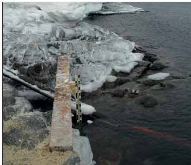
Mesures de tirant d'eau « sabot de mire » (socle scellé sur la roche par plongeur)
