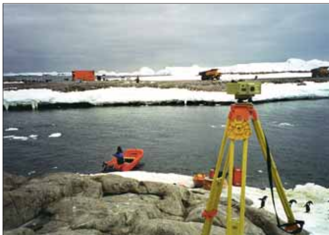
Niveau NA3003 et mire à code barre à travers les rookeries sur l'île des Pétrels (janvier 2000)
