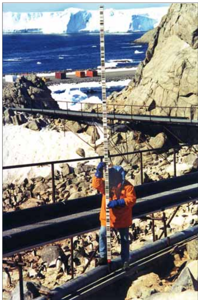
Nivellement à la mire à code-barres et « à la boule de billard »
