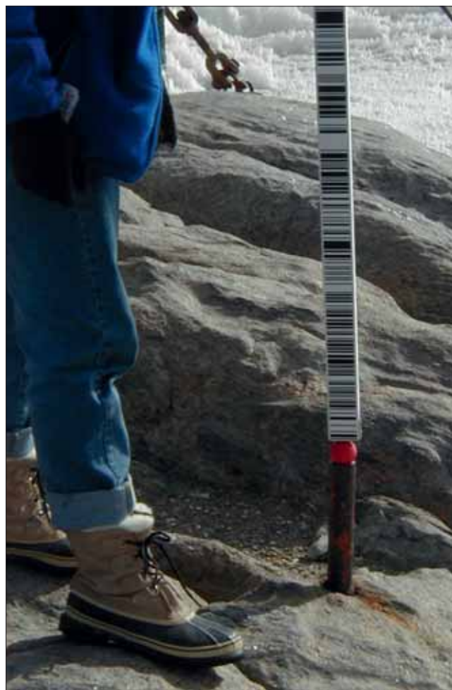
Nivellement à la mire à code-barres et « à la boule de billard »
