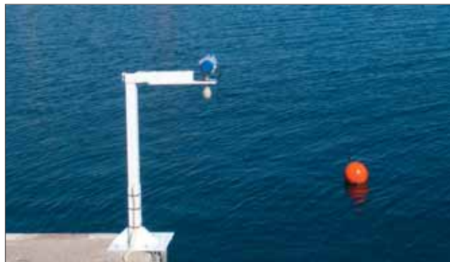
Fig.5 : Capteur Optiwave sur potence à Solenzara
