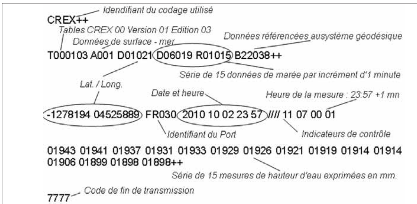
Fig. 12 : Format et codage d'un message transmis sur le SMT
