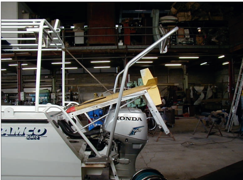
Photo n° 4 : portique Sonal à l'arrière de la VH7 Chambeyron de la DITTT dans les ateliers de la BHNC à Nouméa.
