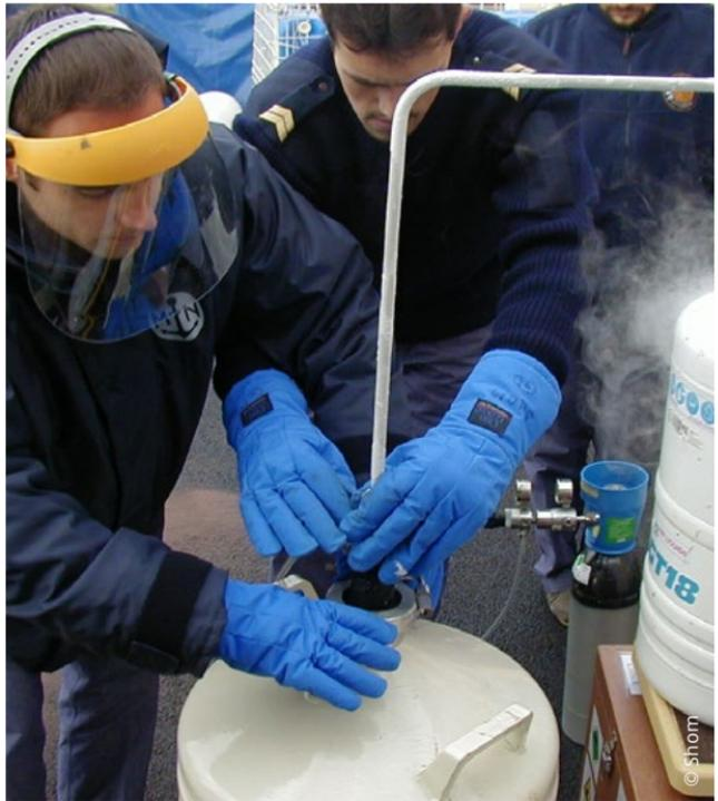
*Manipulation d'échantillons conservés dans l'azote liquide*
