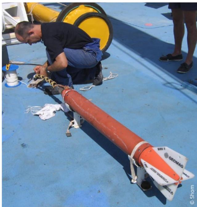
Mise en œuvre du magnétomètre SMM II
