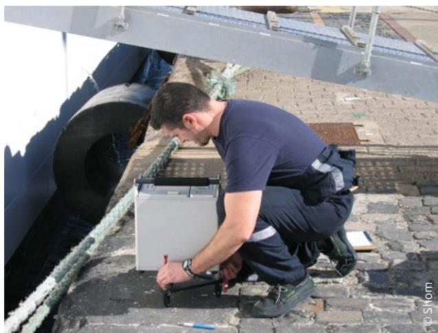
Mise en œuvre du gravimètre terrestre Scintrex
