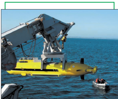
Mise à l'eau du prototype de l'AUV Daurade
