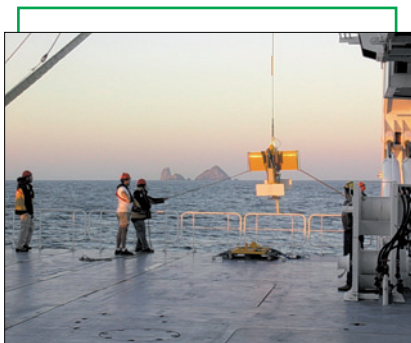
Mise à l'eau d'un poisson ondulant remorqué, porteur d'une bathysonde
