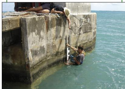
La technologie numérique ne dispense pas encore du recours aux échelles de marée pour le contrôle du bon fonctionnement des marégraphes. Tubuai, 2008
