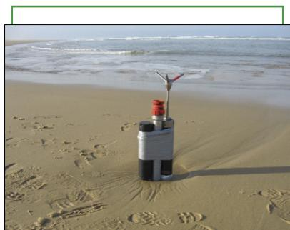
*Essai de stabilité d'un courantomètre immergé ensablé*
