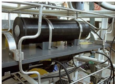
Première utilisation du capteur optique de nitrate ISUS, ici installé sur une bathysonde
