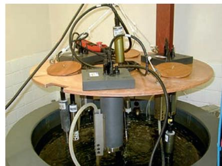
Immersion de thermosalinomètres "Coriolis" dans la cuve d'étalonnage
