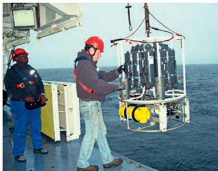
Déploiement d'une bathysonde avec bouteilles de prélèvement et profileur de courant
