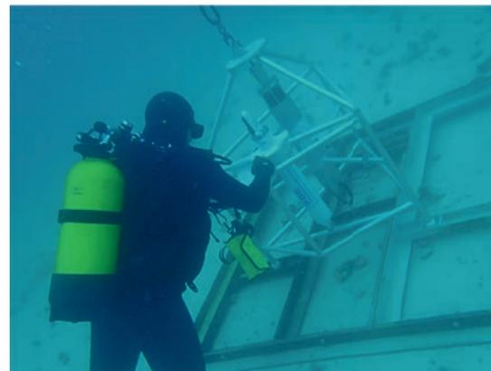
Mouillage d'un marégraphe par plongeur
