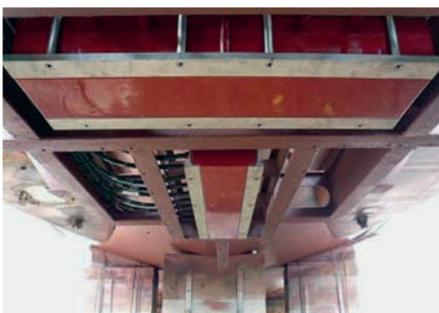
Antenne d'émission et de réception du SMF EM 710 avant la mise en place du carénage complet
