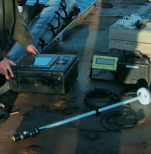
Système SIREP (perche avec antenne GPS et sondeur, système de guidage, valise intégrée comprenant le récepteur GPS, le système d'acquisition et l'énergie)
