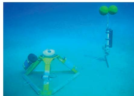
Cage équipée d'un profileur de courant et d'un système de récupération
