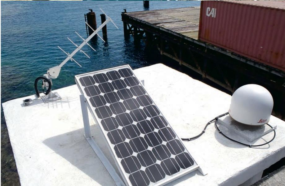
Station marégraphique de Futuna et équipements sur le toit (antenne satellite, panneau solaire et antenne GPS pour le suivi du niveau moyen des mers)
