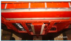
Intégration du sondeur sur la coque du BH Borda lors de l'arrêt technique.
