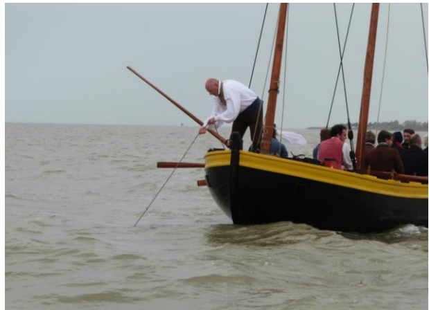
©Shom-D.Beneteau Remontée du plomb de sonde
