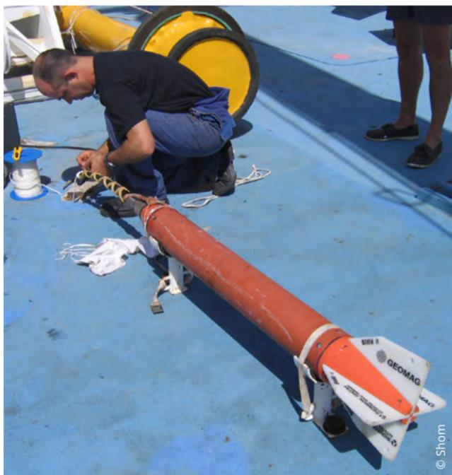
Mise en œuvre du magnétomètre SMM II
