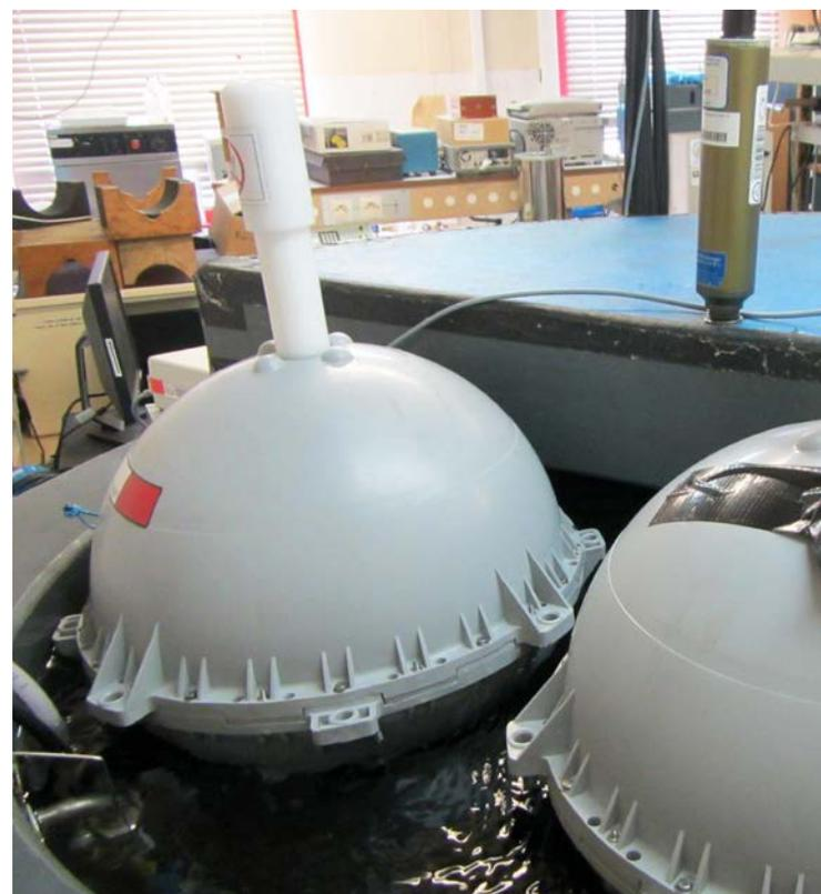
Étalonnage en température des bouées TRUSTED au sein du laboratoire de calibration et d'étalonnage du Shom.
